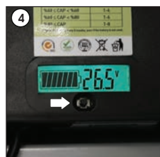
Battery voltage (20 - 26,6) Volt
