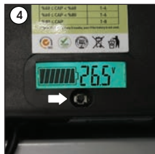
Battery voltage (20 - 26,6) Volt
